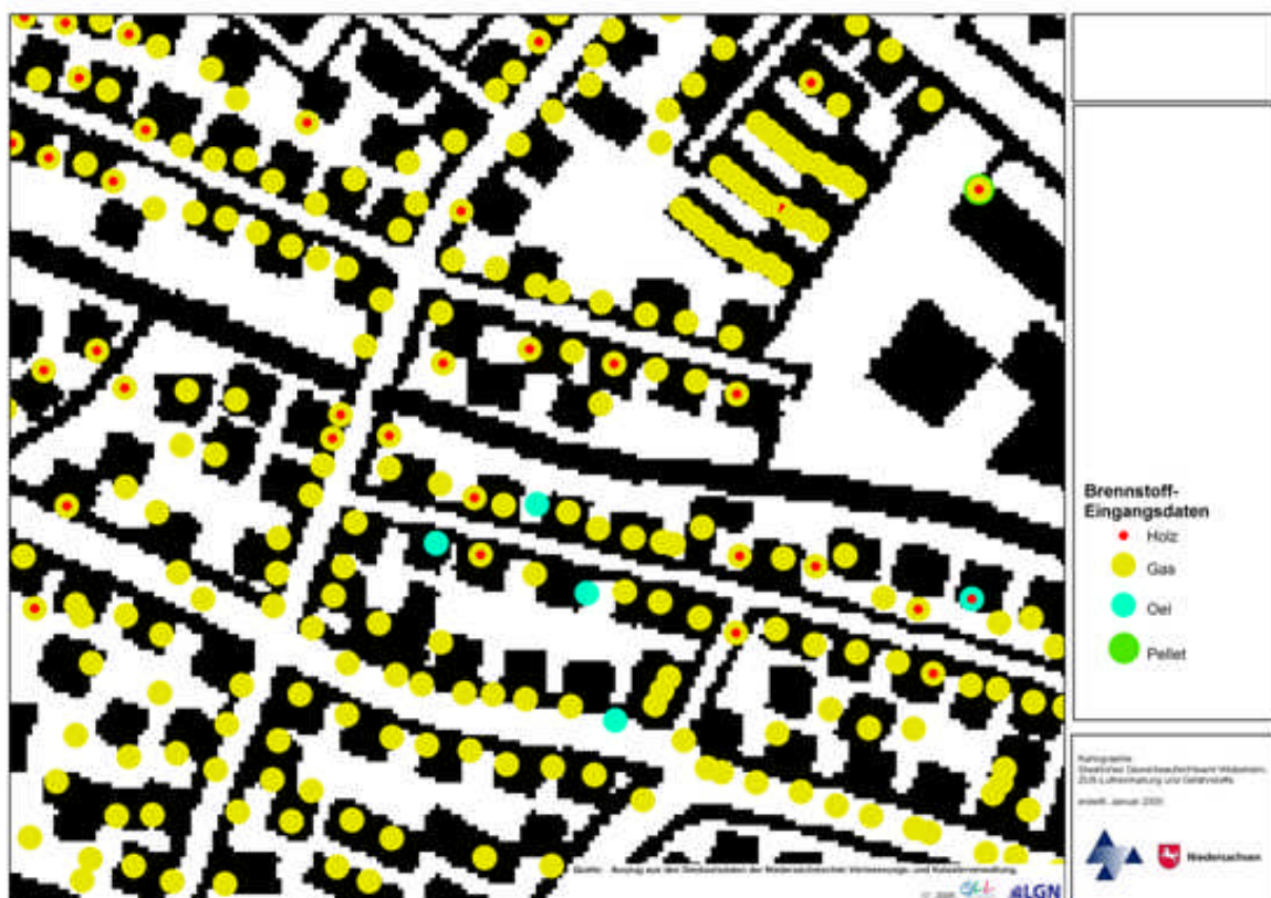
Abbildung 3-13: Datengrundlage zur Hausbrandberechnung (Beispiel), aufgeschlüsselt nach den Brennstoffen Öl, Gas, Festbrennstoffe und Pellets
