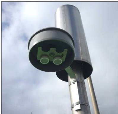
Abb. 11: IVL-Passivsammler im Wetterschutzgehäuse
