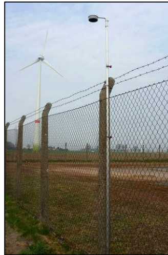
Abb. 12: IVL-Passivsammler, Befestigung am Standrohr
