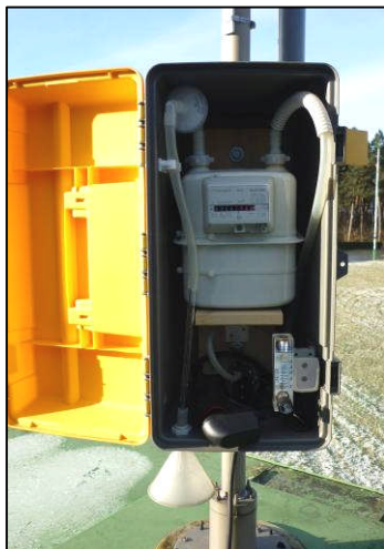
Abb. 10: Minidenuder-System (UBA) im Messkoffer
