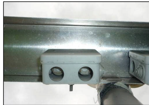
Abb. 14: Zürcher-Passivsammler (LWK-NI), Untersicht
