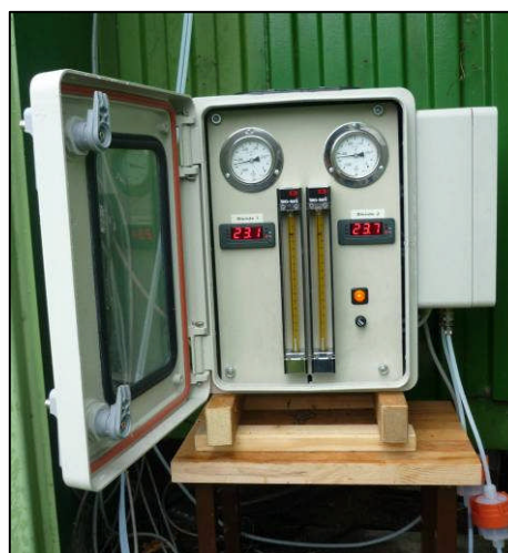
Abb. 7: Probenahmegehäuse, Denudersystem (GAA-HI)
