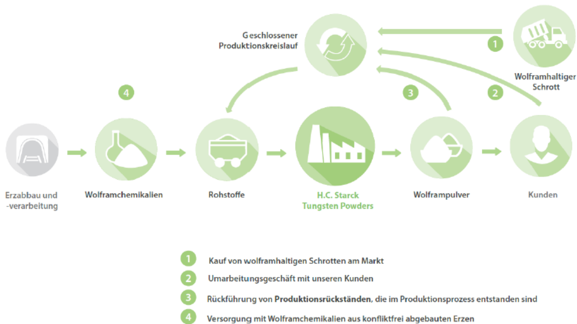
Abbildung 11: Erläuterung des Closed-Loops bei H. C. Starck Tungsten GmbH 20
