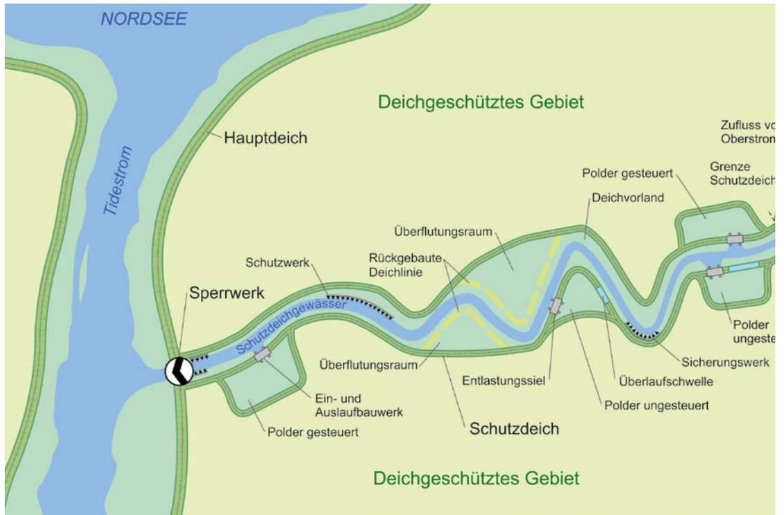
Abbildung 3.3.6: Schutzdeichsystem oberhalb eines Sperrwerks (schematisch) (NLWKN 2020).
