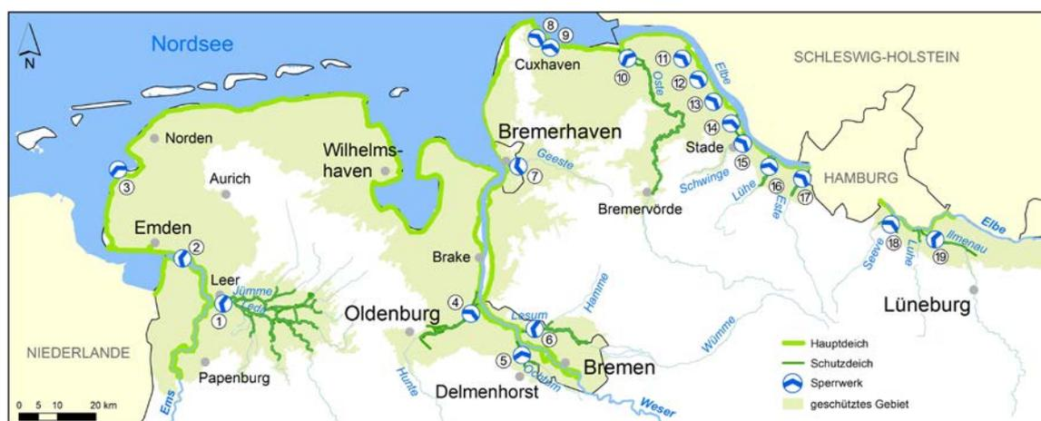
Abbildung 3.3.2: Deichgeschütztes Gebiet, Haupt- und Schutzdeiche sowie Sperrwerke an der Festlandsküste (NLWKN 2020)
