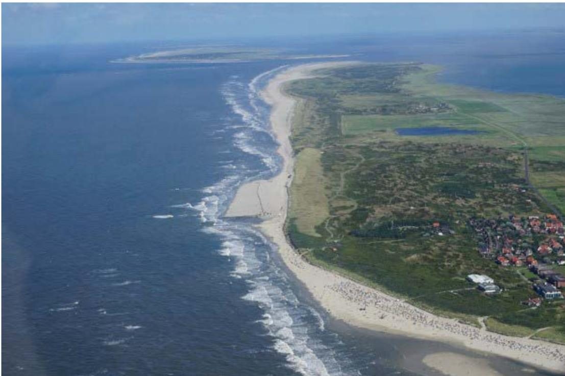
Abbildung 3.3.8: Bauen mit der Natur: Sicherung einer Schutzdüne auf Langeoog durch eine Strandaufspülung (NLWKN).
