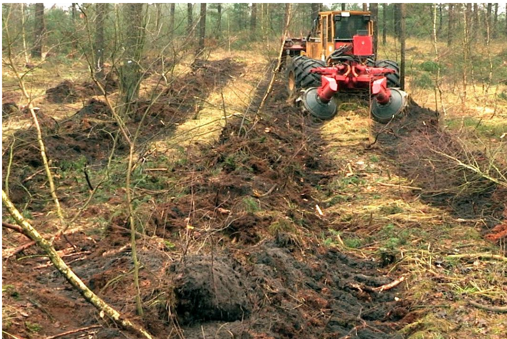
Zulässige flächige Befahrung: Streifenweise Bodenvorbereitung (NLF)
